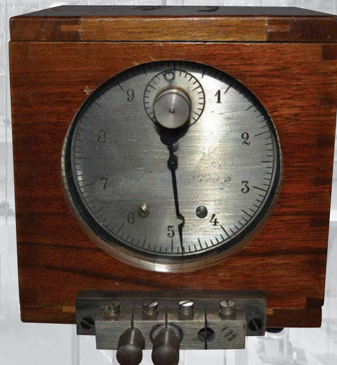
Контрольный счетчик однофазного тока, 1929 г.
