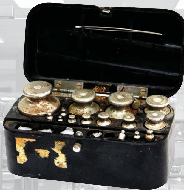
Гири общего назначения 4-го класса Г-4-1111-10 Нижнетагильский медико-инструментальный завод, г. Нижний Тагил
