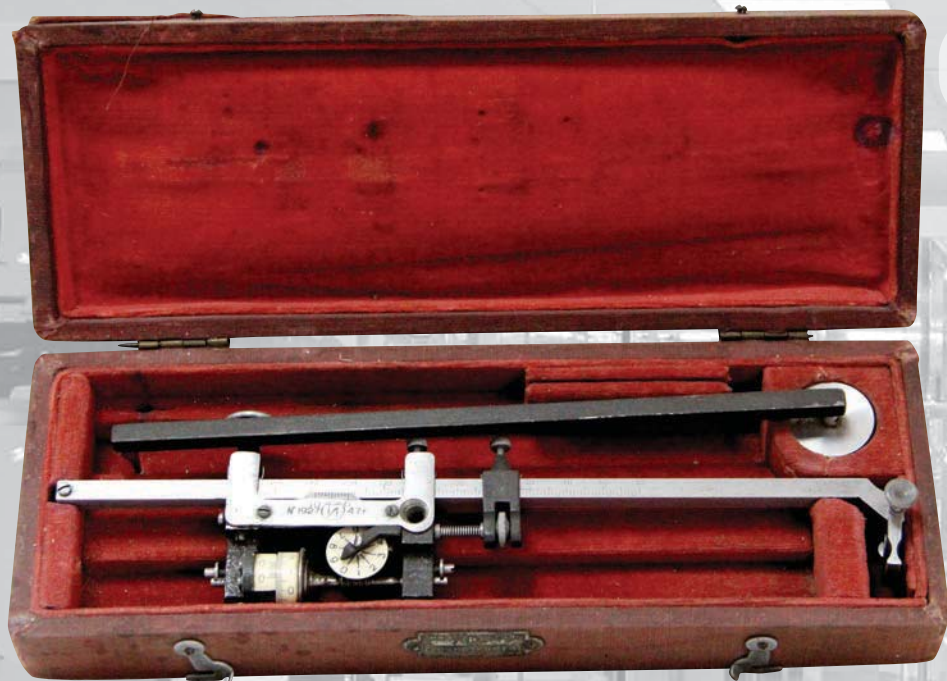
Планиметр полярный Амслера Изготовитель: НКЗ СССР ГУЗ Геоинструмент, ст. Луговая Савеловской жд, 1947 г.
