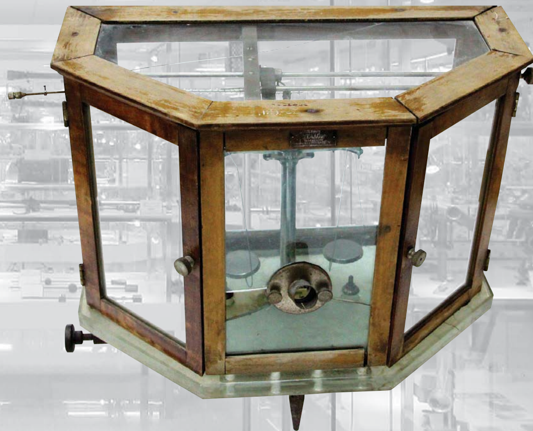
Весы с оптической системой отсчета 1 разряд Изготовитель: Экспериментальный завод «Эталон», ВНИИМ, г. Ленинград, 1939 г.
