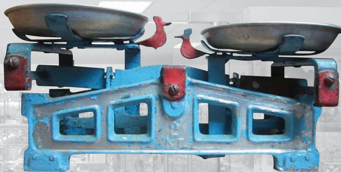
Весы рычажные торговые, применялись в середине XX века. Верхний предел измерения – 2 кг.
