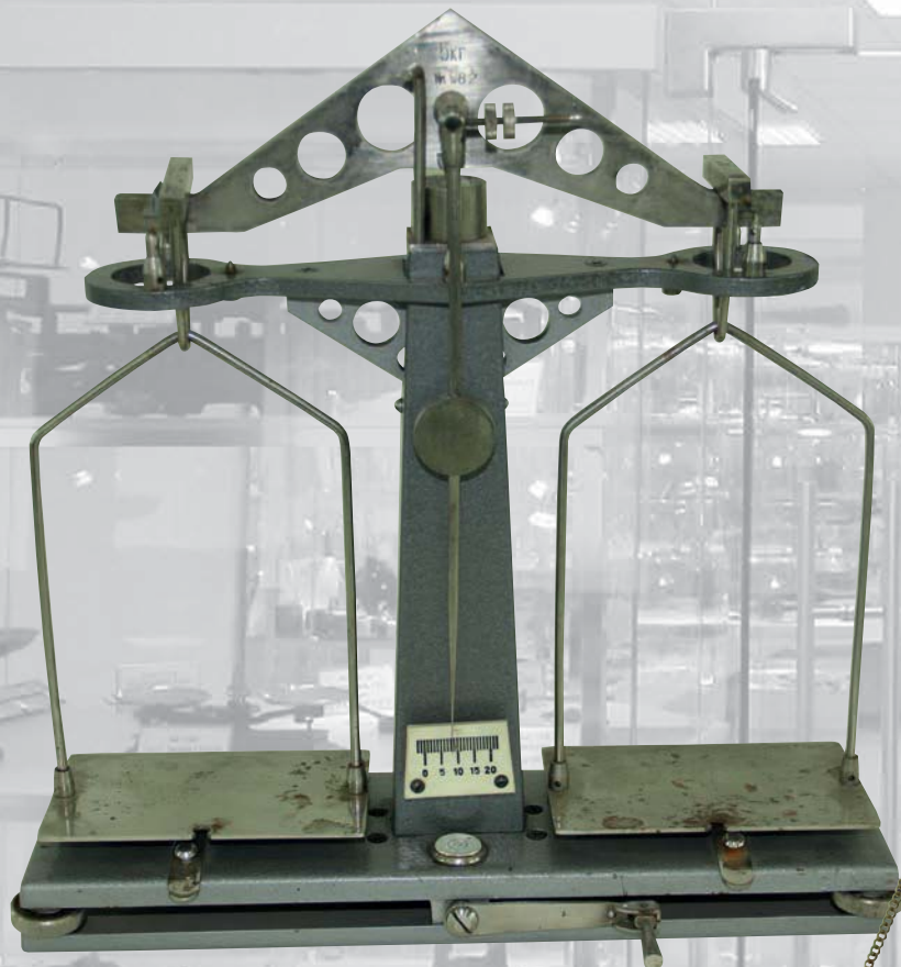
Весы образцовые разъездные 4-го разряда с комплектом гирь образцовых 4-го разряда НРО-5кг-4М. 200 г – 5 кг. Прибороремонтный завод Ставрополь, 1981 г.
