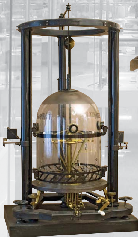
Эталонные весы № 2 Главной палаты мер и весов. Австро-Венгрия, Вена. Механик И. Неметц по идее проф. И. Круспера, 1895 г. Д. И. Менделеев писал: «Весы эти... составляют во многих отношениях новый успех в деле устройства точных весов, так как ... не только обладают большой чувствительностью и хорошим постоянством, но и допускают при этом взвешивания в безвоздушном пространстве, так как держат пустоту в течение 20 часов».
