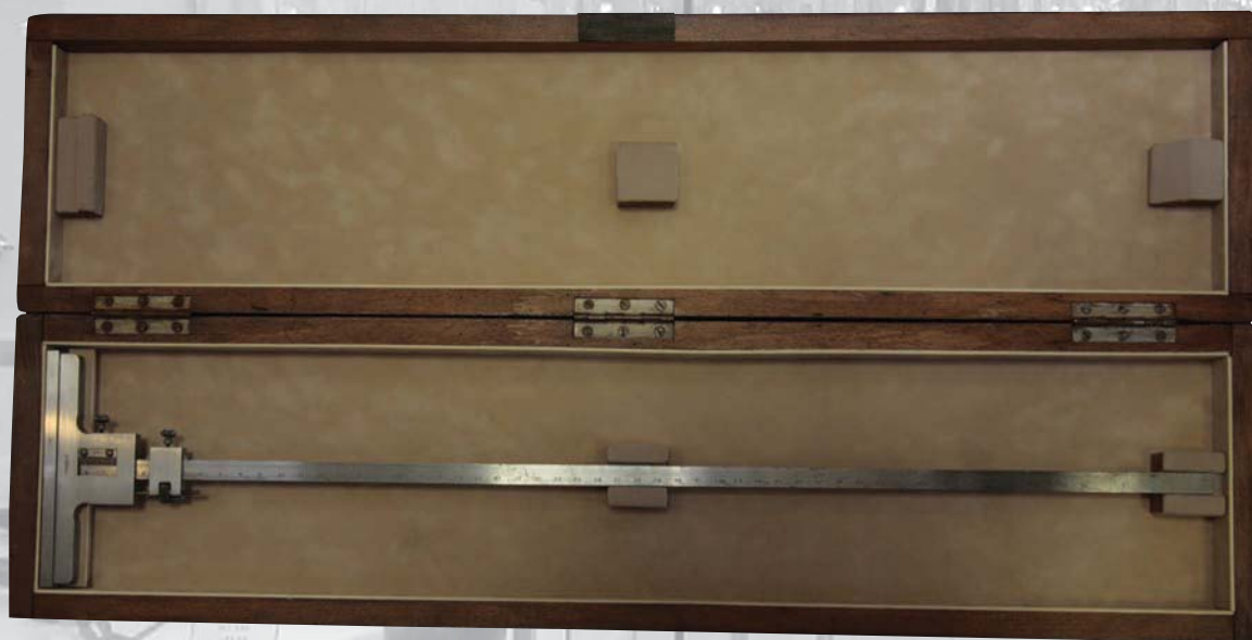
Глубиномер точность счета 0,02 мм. и 0,001 дм., пределы измерения: от 0 до 500 мм. Госзавод «Красный инструментальщик», г. Ленинград, 1938 г.
