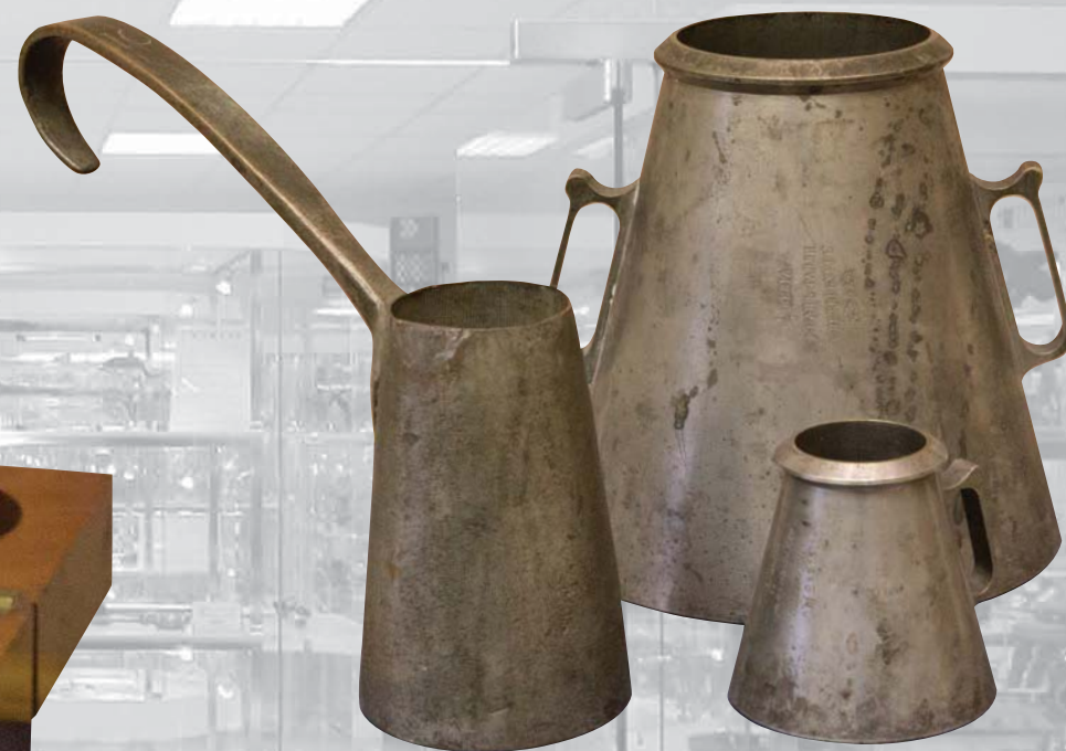
Образцовые меры объема для жидких тел: 1/2 и 1/20 ведра фирмы Сан-Галли (г. Санкт-Петербург), XVIII в. Питейная мера из литой бронзы на 10 чарок (на фото – слева), использовалась при производстве алкогольных напитков и в питейных заведениях, XIX в.
