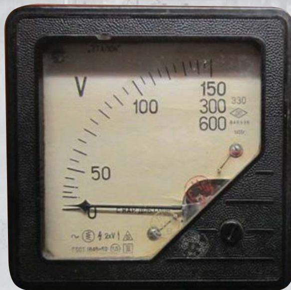
Вольтметр, предел измерений от 0 до 600 В Изготовлен заводом ЗИП в 1955 г.
