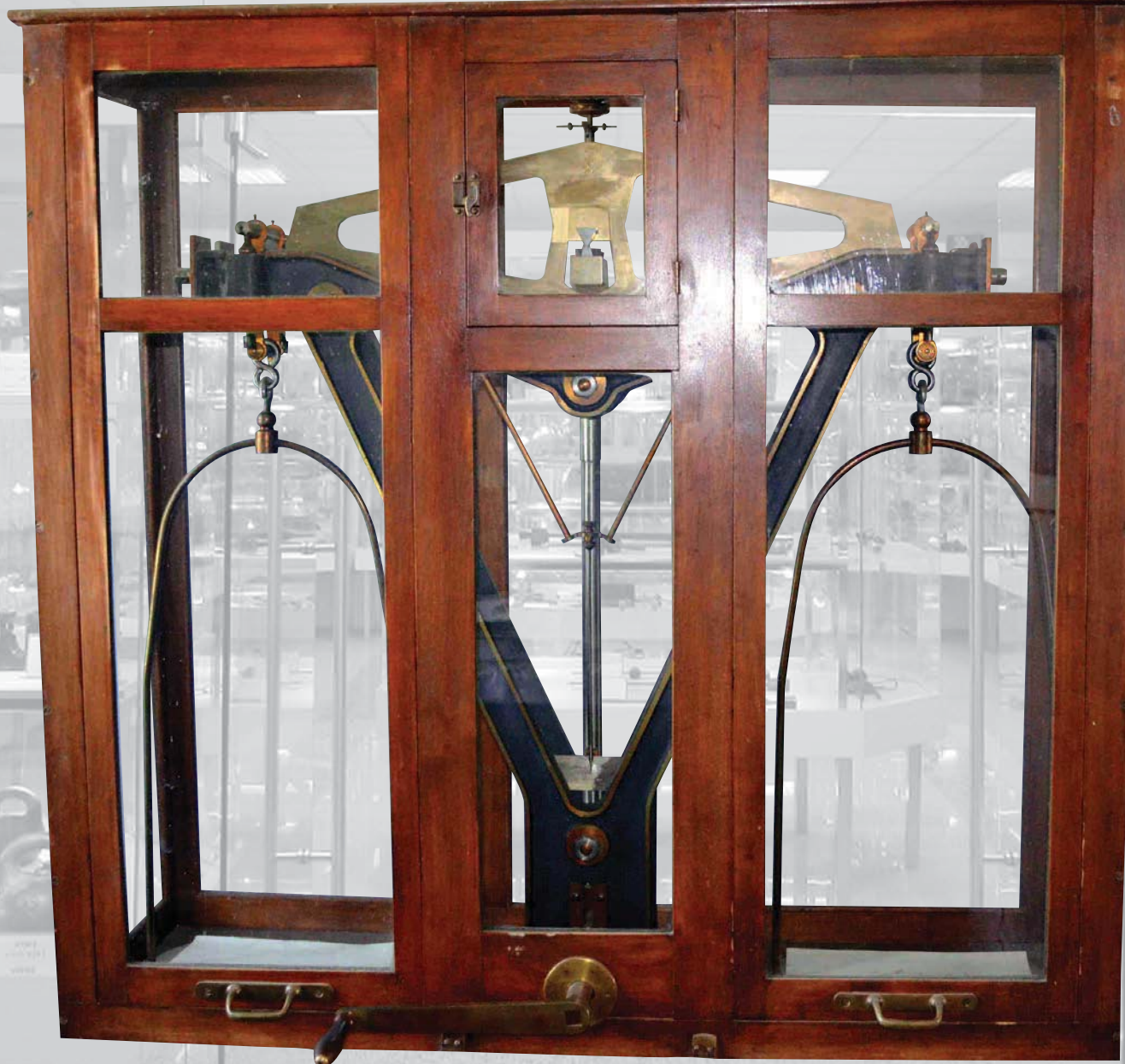
Весы лабораторные образцовые (ВЛО-50) до 50 кг Изготовитель: Мастерская точных весов Глазметровес, 1958 г.
