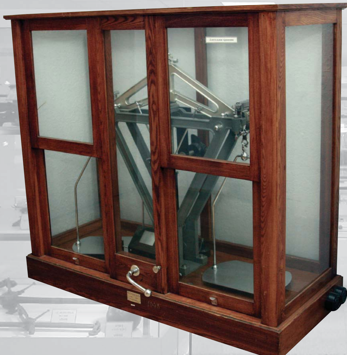
Весы образцовые 2 разряда, предельная нагрузка 20 кг «Эталон», г. Рига, 1954 г.
