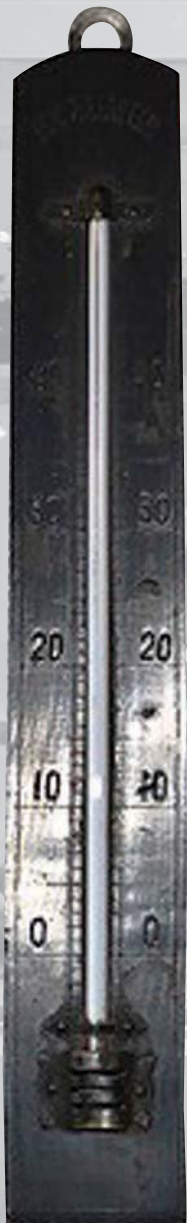
Термометр Реомюра ртутный 1 градус по шкале Реомюра = 1,25 градуса Цельсия Франция, конец XVIII века
