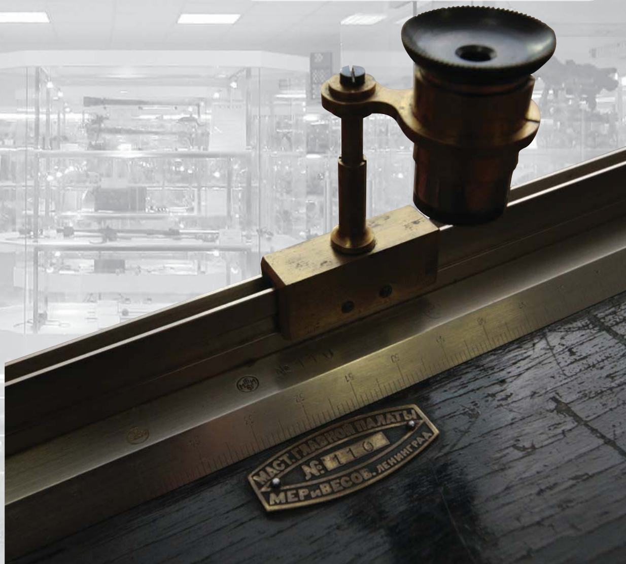
Мера длины штриховая, тип IV, (0–1000) мм, 3 разряда Мастерская главной палаты мер и весов, г. Ленинград, 1949 г.
