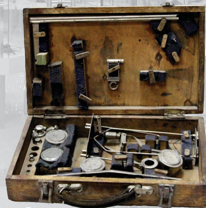
Весы разъездные образцовые с тремя коромыслами Изготовитель: Завод «Ремоприбор», г. Минск, 1961 г.
