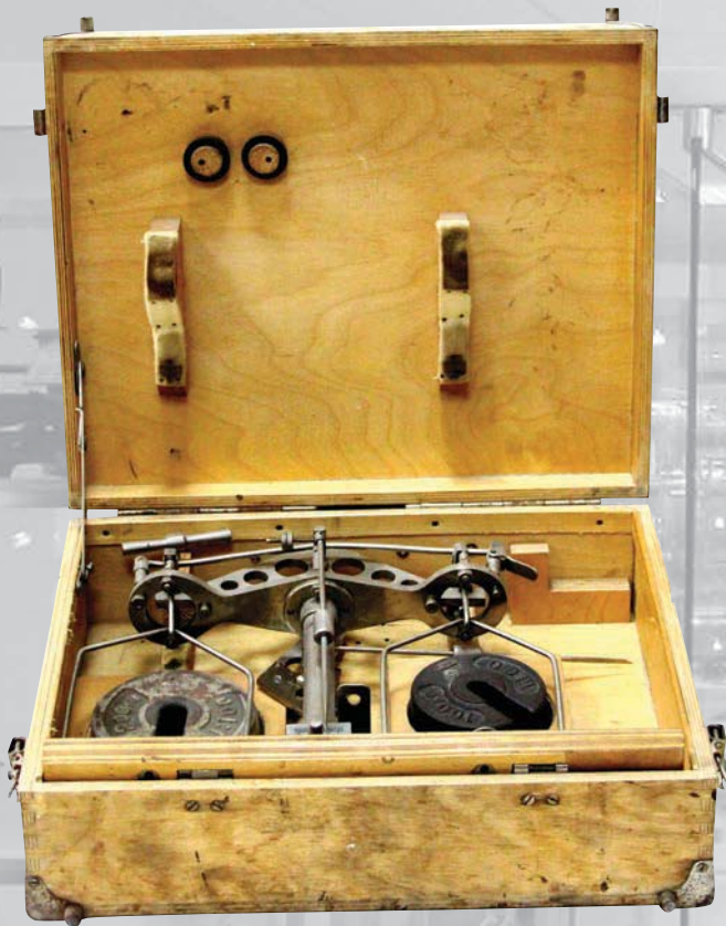
Весы лабораторные образцовые разъездные НРО-5 Ставропольский приборостроительный завод, 1972 г.
