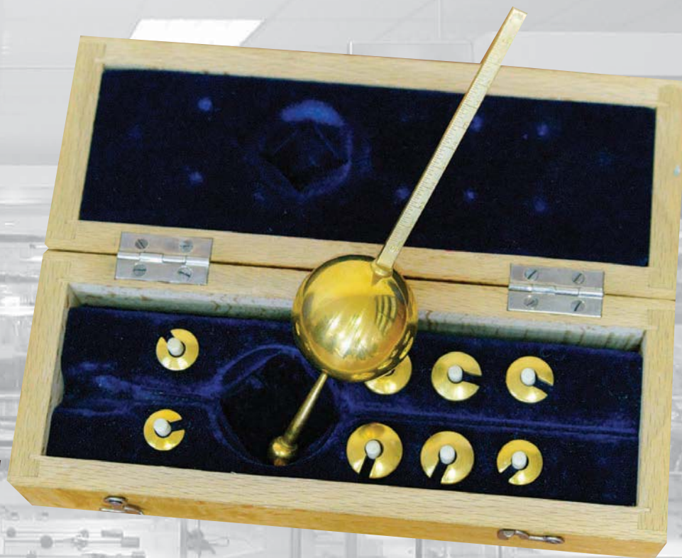
Спиртомер образцовый II разр. 20°C ГОСТ 3638-53 ПСХ УПП Ленпищемашзавод, г. Ленинград, 1955 г.
