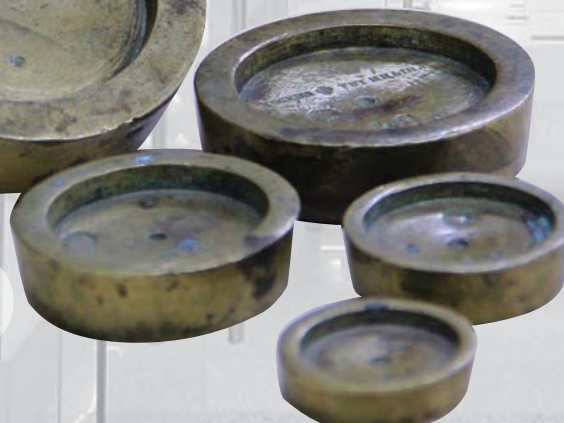
Гиря разборная 5 фунтов, фабрика Тугицына, г. Москва, 1856 г.
