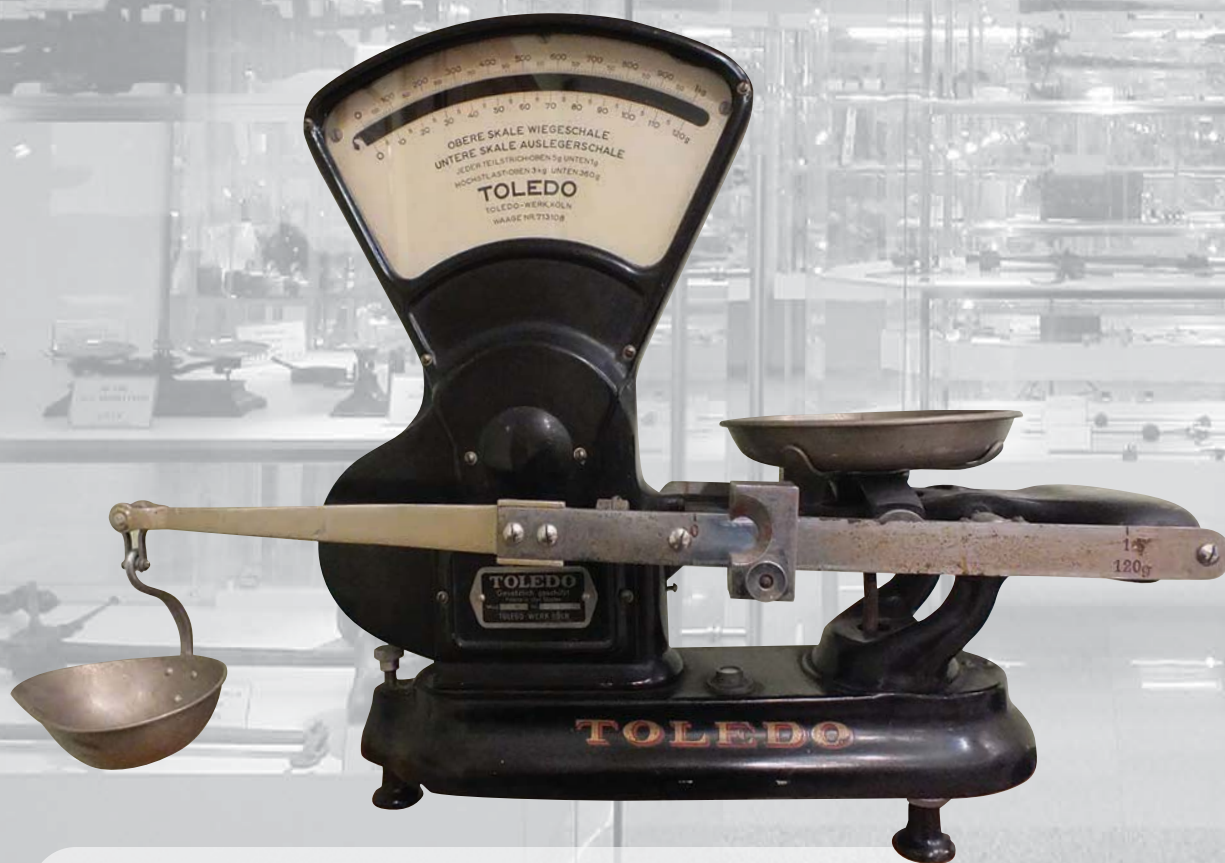
Специальные весы фирмы «Тоledo», США. Изготовлены в период с 1920 по 1940 годы на заводе «Тоledo» в г. Кёльн, Германия. Две шкалы взвешивания с пределами 120 г и 1 кг.
