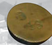
Русский складной фунт. Изготовлен в частной мастерской Стрекопытова, поверен в 1911 г.
