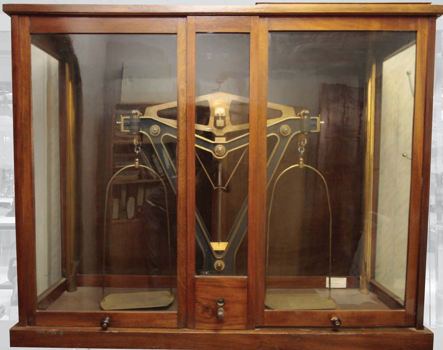
Весы эталонные ВЛО-50, III разряда, до 50 кг, 1939 г. применялись для поверки эталонных гирь IV разряда
