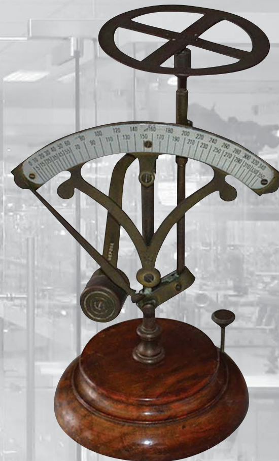
Почтовые весы коллекционные предназначены для взвешивания конвертов и бандеролей массой до 350 г. Франция, конец XIX века
