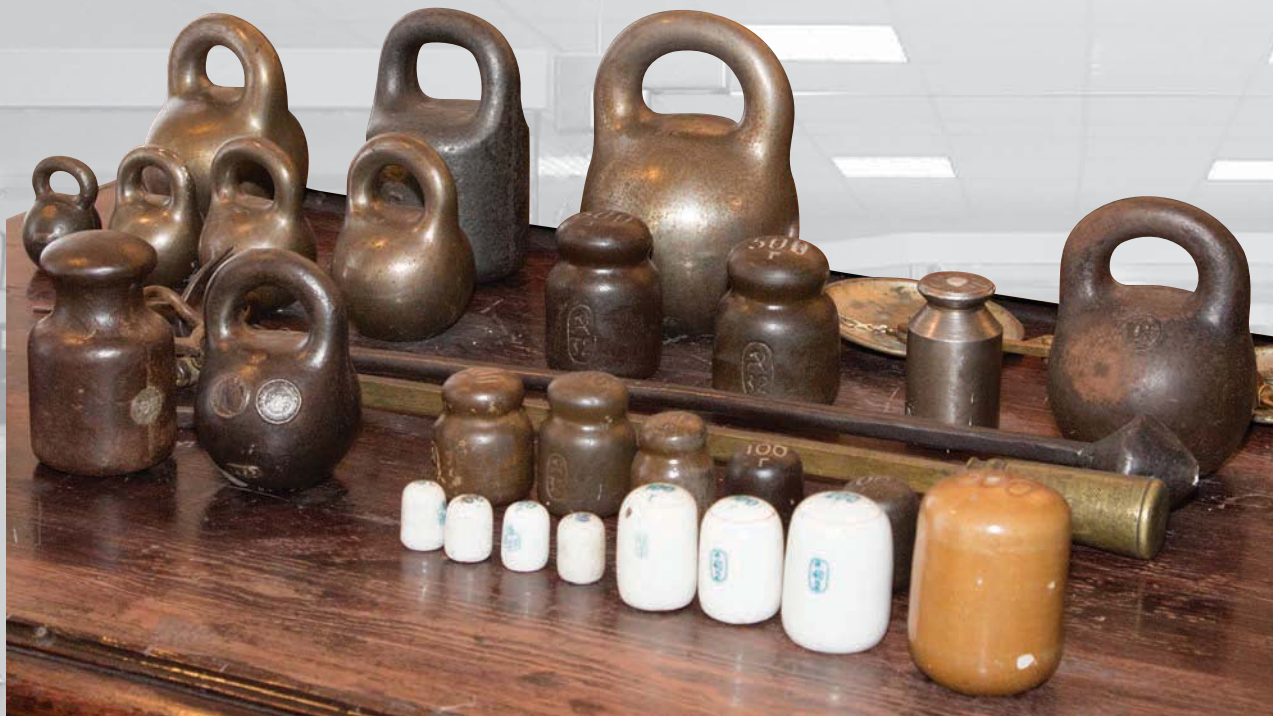
Торговые гири — металлические и фарфоровые, XVIII–XIX вв. В отличие от металлических, фарфоровые гири было невозможно рассверлить в целях уменьшения их веса.
