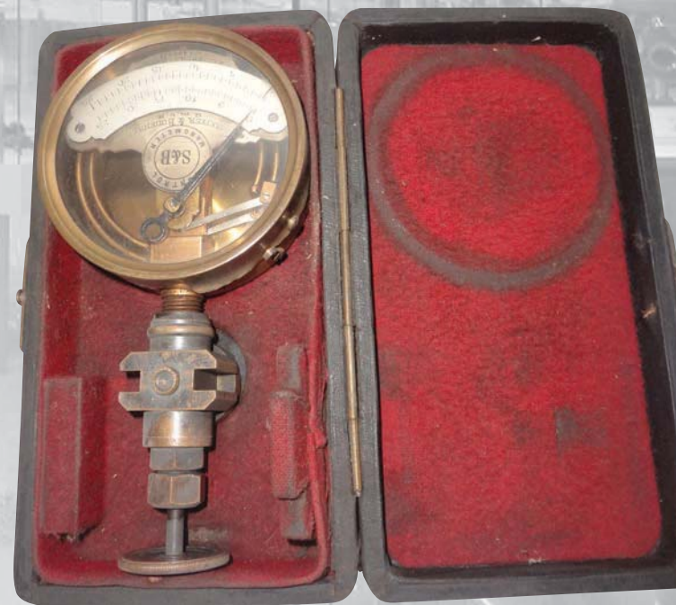
Манометр контрольный Фирма Schaeffer&Budenberg, Германия первая половина XX века
