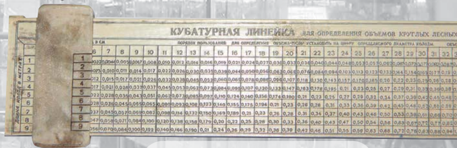
Кубатурная линейка для определения объемов круглых лесных материалов
