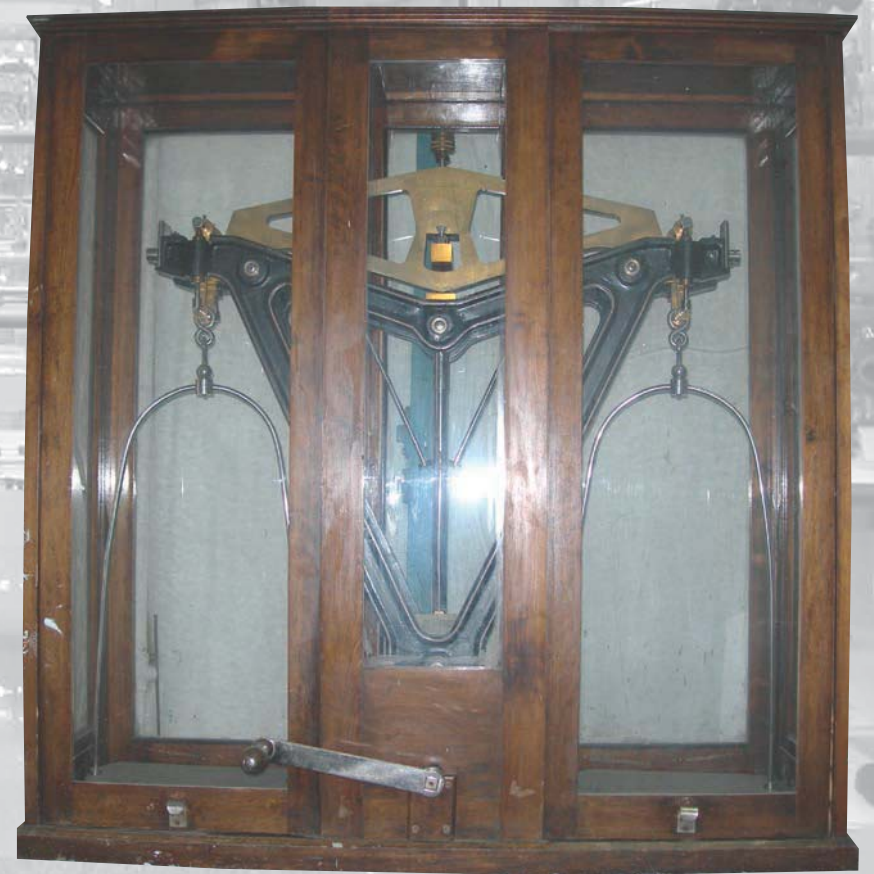
Весы образцовые рычажные с НВП 50 кг. Завод-изготовитель: 1-й ГОС.ВЕС. ЗАВОД «МЕТАЛЛТРЕСТ», г. Одесса, 1927 г.
