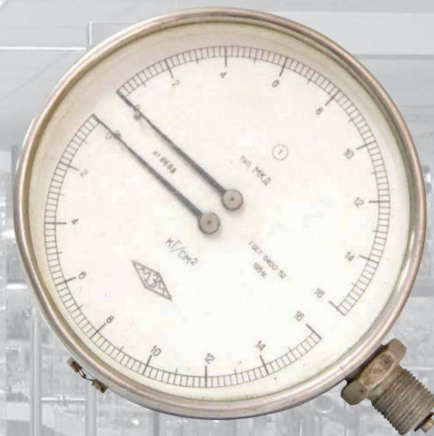
Манометр МКД Изготовитель: Завод «Манометр», г. Москва, 1956 г.
