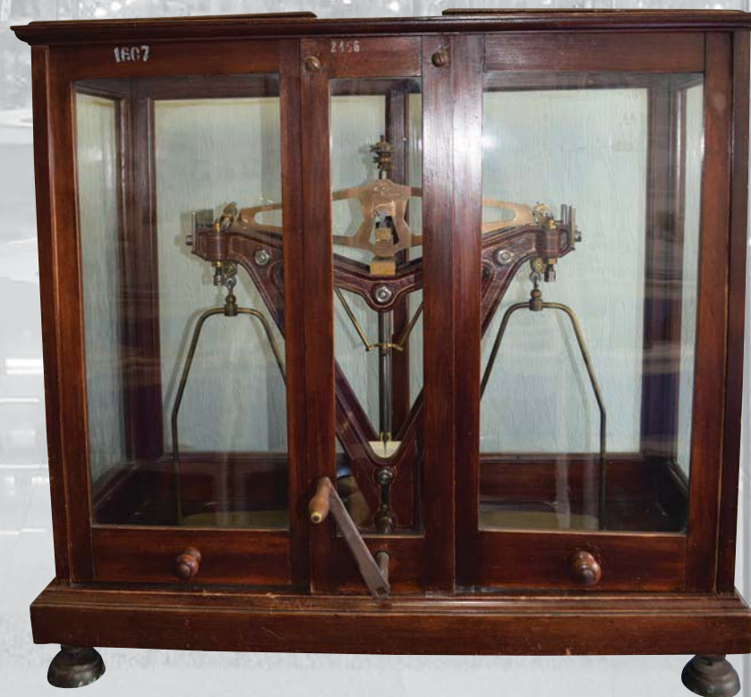
Весы образцовые равноплечие 3 разряда, 1905 г.
