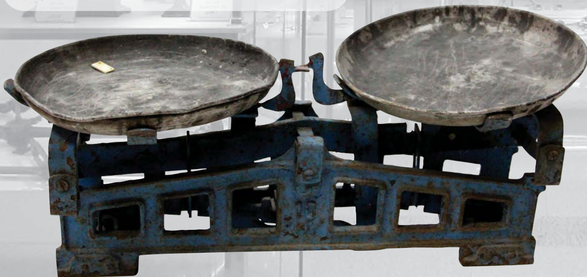
Весы настольные гирные рычажного типа с указателями равновесия с открытым весовым механизмом ВНО-10
