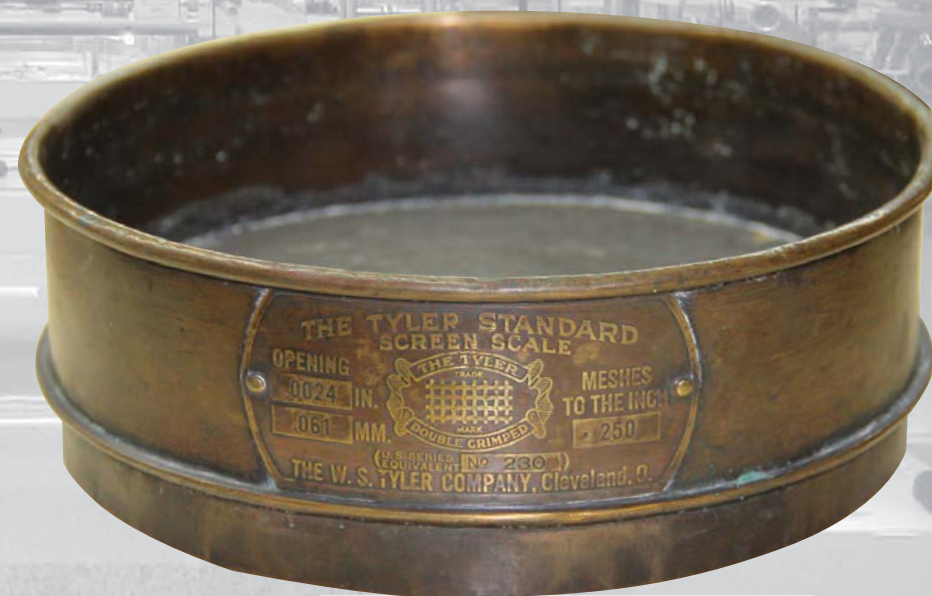
Сито лабораторное, размер ячеек 0,061 мм США, начало XX века.
