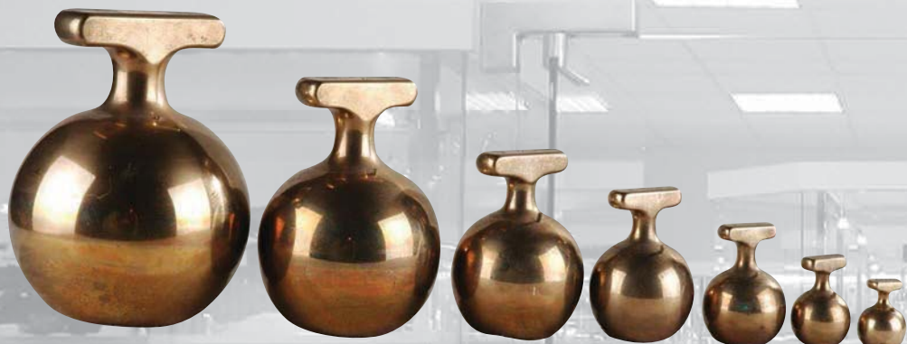
Образцовые гири для проверки мер объема. Россия, г. Санкт-Петербург. Механик И. Горячев. Конец XIX в.
