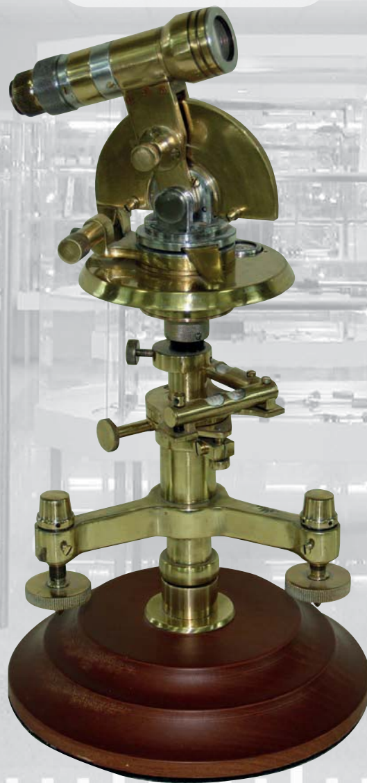
Угломер-тахеометр горный УТГ.ЗМИ. Харьков, 1970 г.
