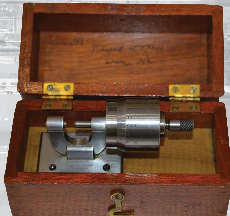
Микрометр гладкий Диапазон измерения от 0 до 0,5 дюймов. Точность измерения 0,0001 дм Фирма Brown&Sharpe Mfg.Co, США, 1894 г.
