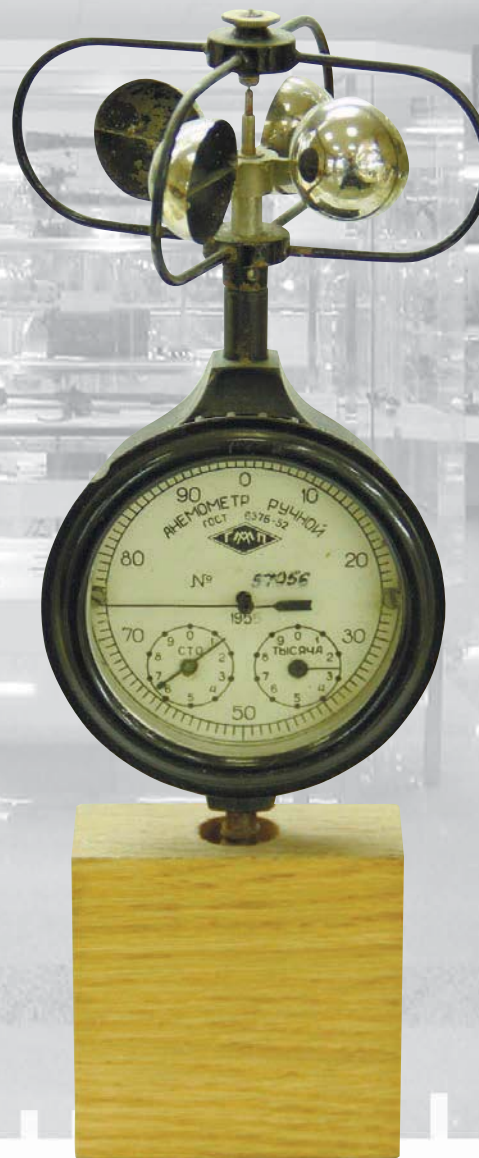
Анемометр ручной чашечный. ГММП, СССР 1956г.
