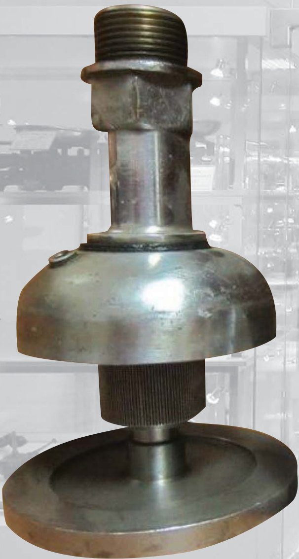
Измерительная система образцового грузопоршневого манометра МОП-60 Изготовитель: Харьковский Коксохимический завод, 1970 г.
