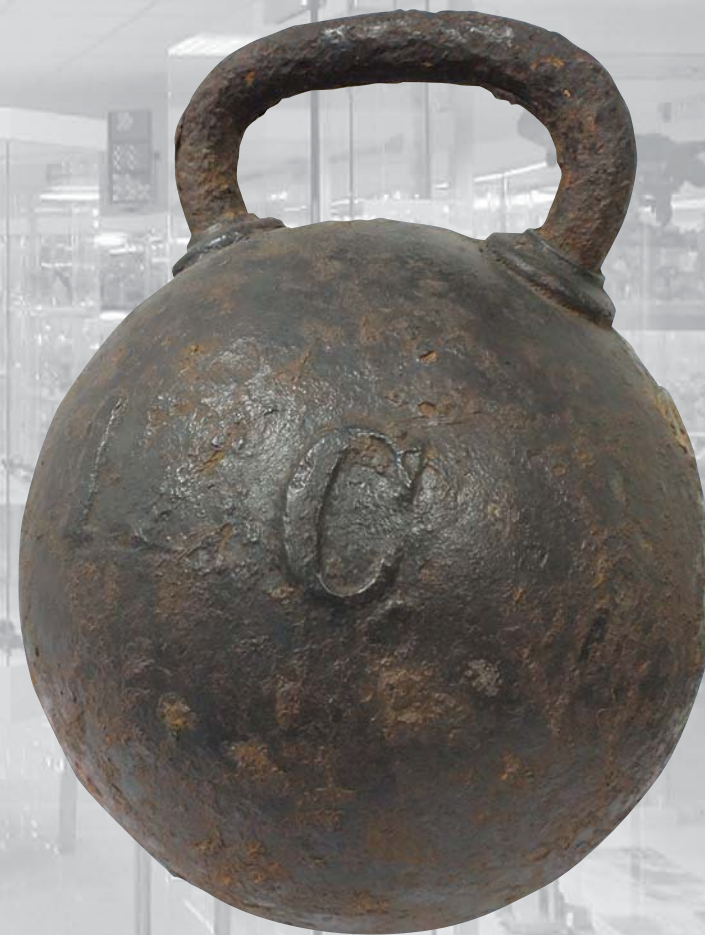
Гиря массой 50 кг Германия, 30-е годы XX века. Последняя поверка — 1940 г (клеймо). Имеет знак внесения в Госреестр Германской Империи.
