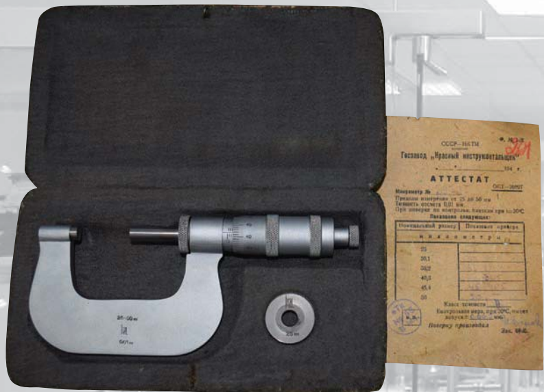
Микрометр (25–50) мм, класс точности 2. Госзавод «Красный инструментальщик», 1942 г.
