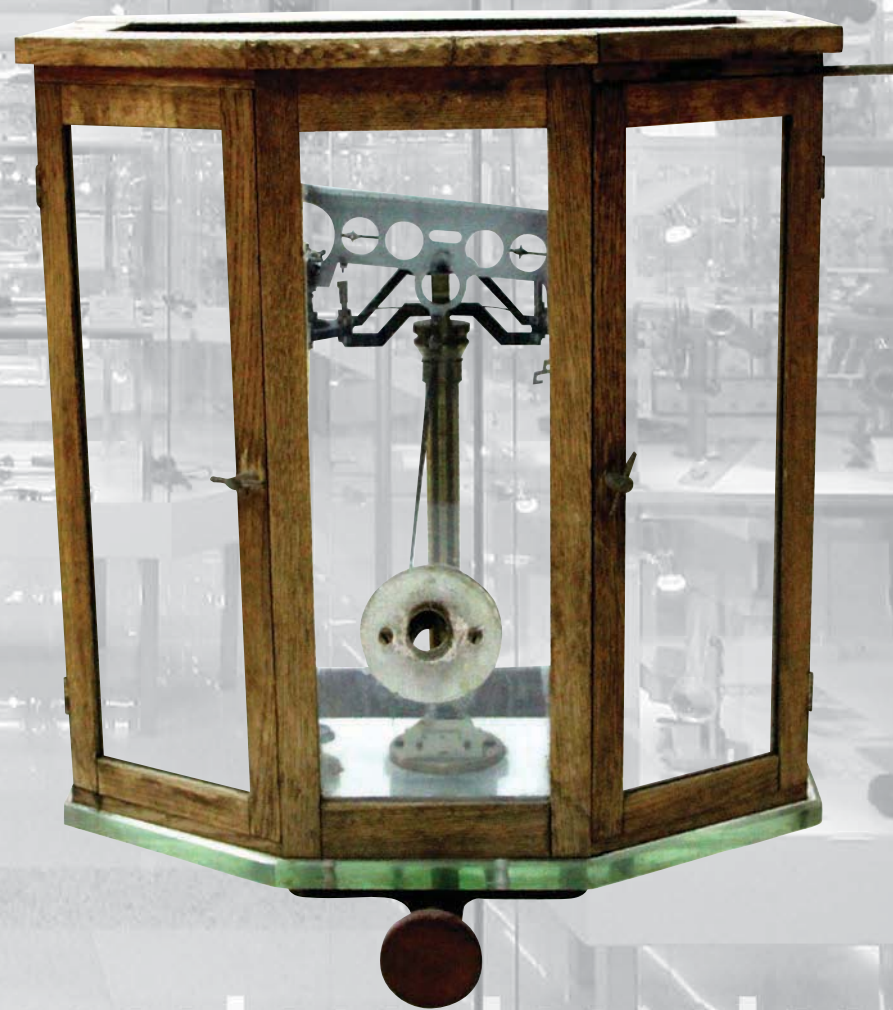
Весы с оптической системой отсчета 1 разряд Изготовитель: Экспериментальный завод «Эталон», ВНИИМ, г. Ленинград, 1939 г.
