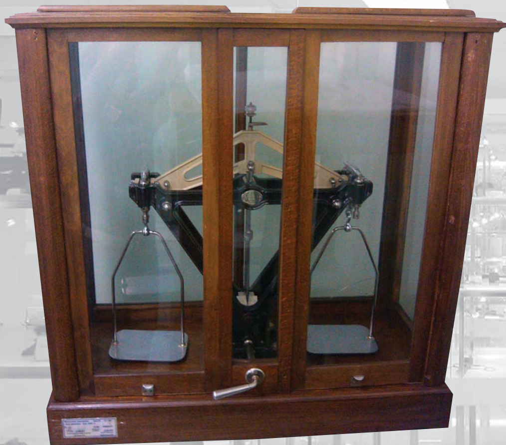
Весы образцовые до 5 кг. 3 разряда, ВЛО-5 1949 г.
