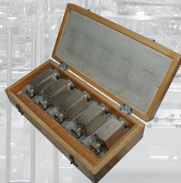
Комплект конденсаторов малой емкости КМЕ-4у ОП НГИМИП, г. Новосибирск, 1962 г.
