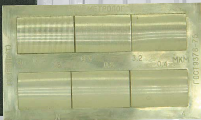
Образцы шероховатости. НПК «Метролог» СССР, 1975 г.
