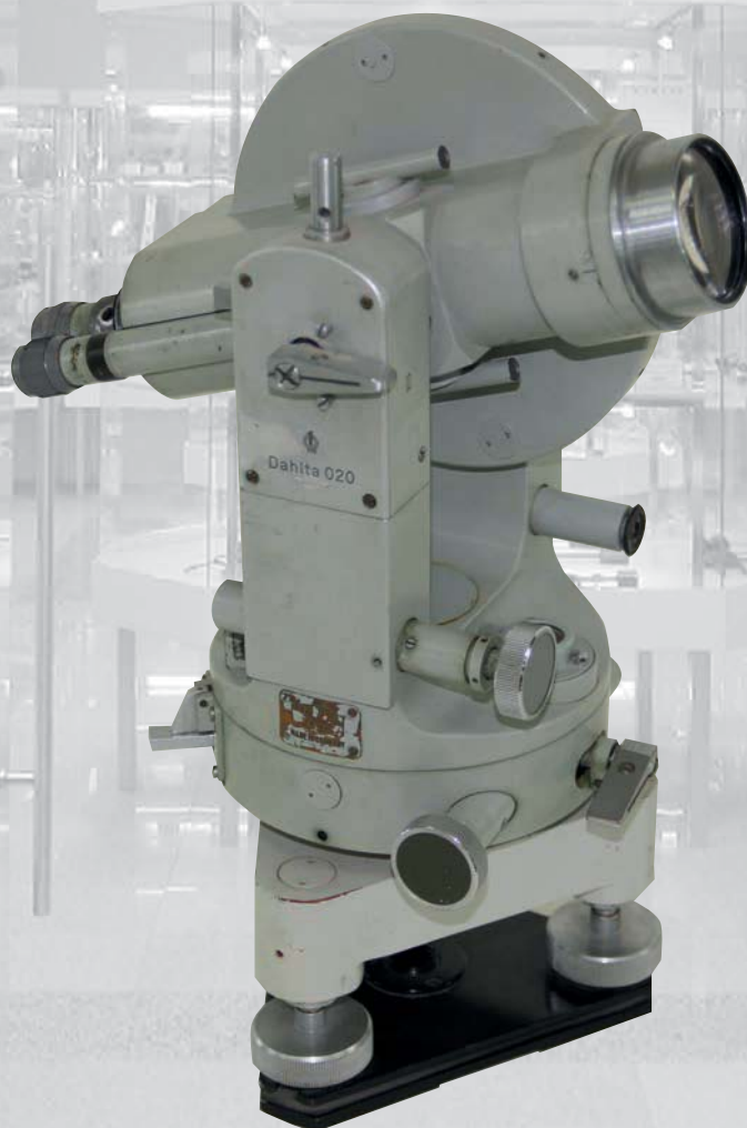
Тахеометр Dahlta-020. Завод «К. Цейсс, Иена». Германия, 1966 г.
