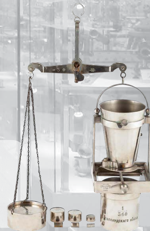
Весы хлебные — Гамбургская пурка в 1/360 голландского мешка (0,2 л). Россия, г. Санкт-Петербург. Механик И. К. Манцевич. Конец XIX в. Служила для определения качества (натуры) зерна при купле-продаже. Названа «гамбургской» по месту ее первоначальной поверки и клеймения.
