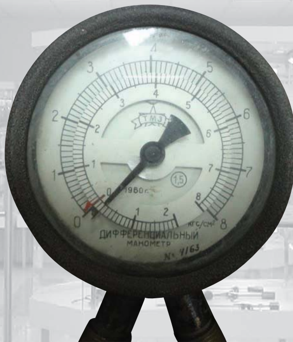
Манометр дифференциальный (для измерения разности давлений) Изготовитель – ТМЗ, 1960 г.
