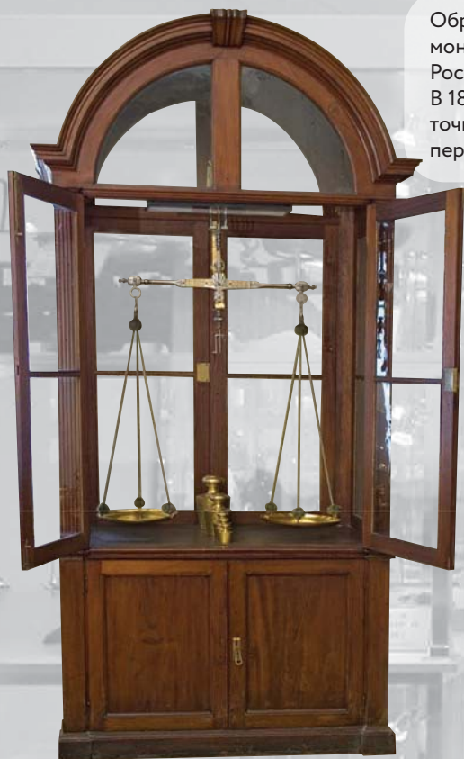
Эталонные весы № 2 Главной палаты мер и весов. Австро-Венгрия, Вена. Механик И. Неметц по идее проф. И. Круспера, 1895 г. Д. И. Менделеев писал: «Весы эти... составляют во многих отношениях новый успех в деле устройства точных весов, так как ... не только обладают большой чувствительностью и хорошим постоянством, но и допускают при этом взвешивания в безвоздушном пространстве, так как держат пустоту в течение 20 часов».
