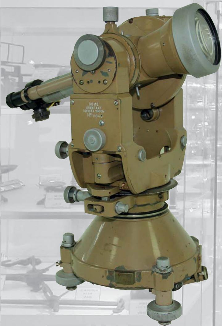
Теодолит ОТ-02М. Завод ЭОМЗ ЦНИИГАиК. Москва, 1963 г.
