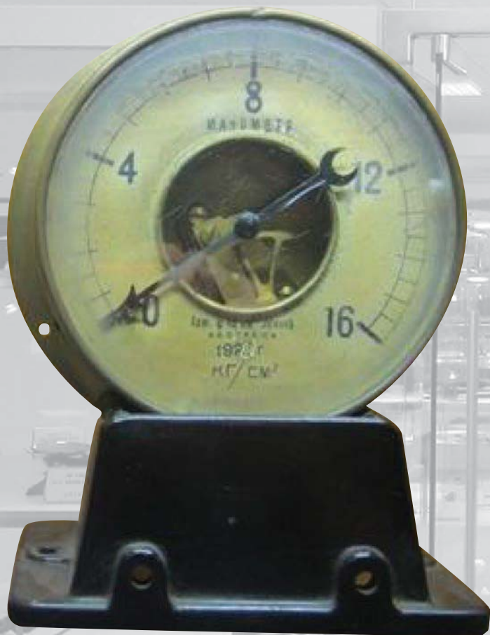
Манометр технический, КТ-2,5 Предел измерений от 0 до 16 кгс/см 2 . Изготовлен в 1929 г.
