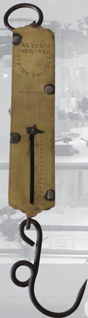
Весы пружинные до 30 фунтов Конец XIX века
