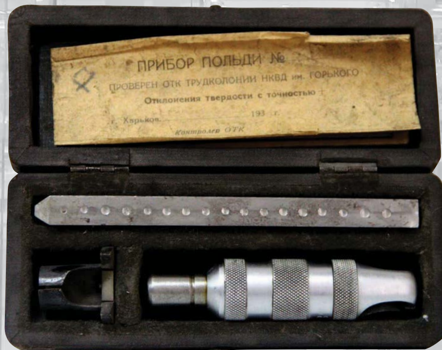
Прибор Польди Твердомер переносной ударного типа — модель Poldi-Hutte.
