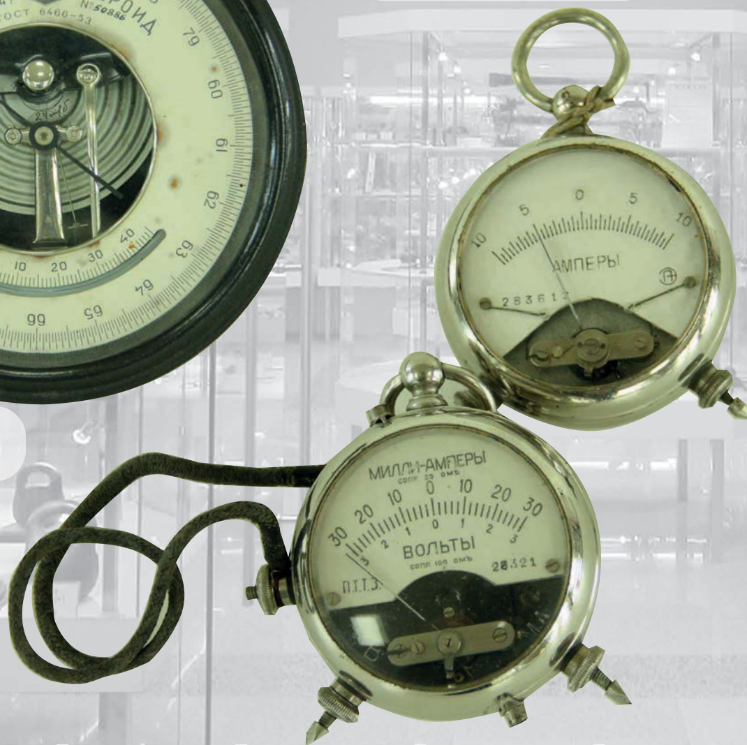
Амперметр, вольтметр малогаба- ритные. Россия, начало XX в.
