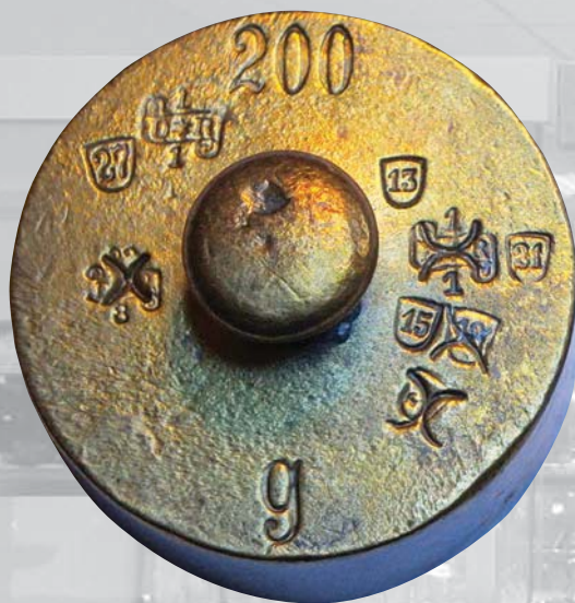
Гирьки 200 г и 50 г Германия, 30-е годы XX века. Отчетливо видны клейма немецких поверителей и знаки внесения в Госреестр Германской Империи.
