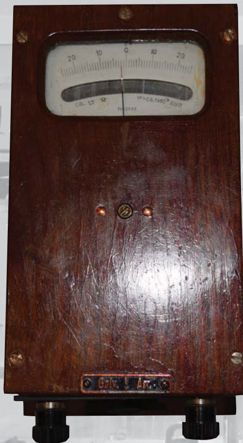
Гальванометр Изготовитель: фирма «Siemens», Германия, 1937 г.
