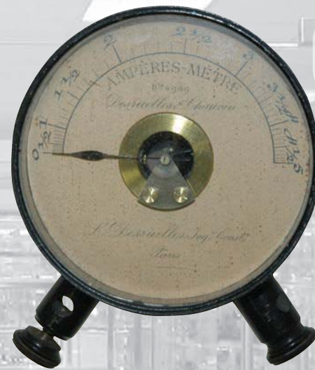
Амперметр постоянного тока Предел измерения точности 5А Класс 2,5 Франция, Париж, начало XX века.
