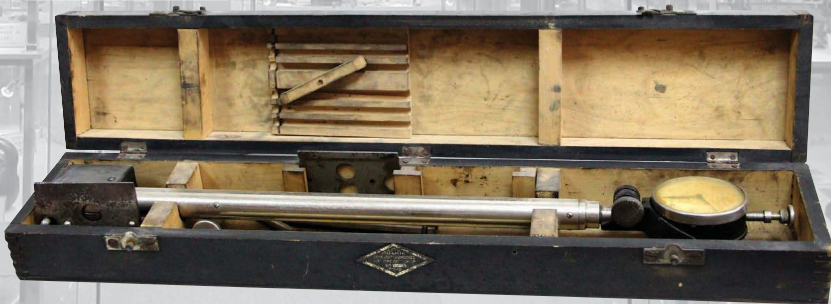
Нутромер индикаторный Изготовитель: «КООПМЕДПРИБОР», г. Ленинград, 1950 г.
