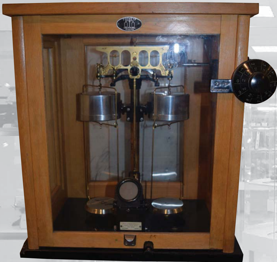
Весы лабораторные (аналитические) Изготовитель: завод «Госметр», г. Ленинград, 1956 г.
