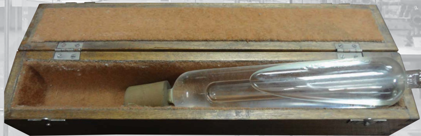
Ампула тройной точки воды Изготовлена ВНИИМ им. Менделеева, середина XX века.
