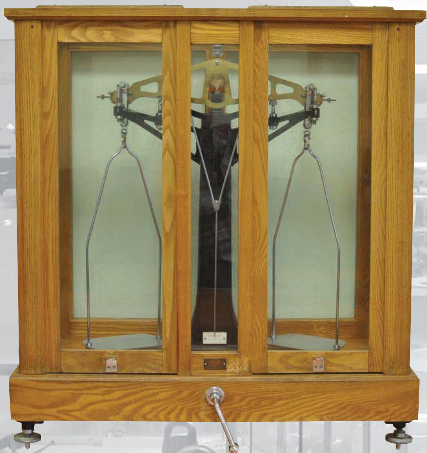
Весы образцовые ВЛО-III-5 кг Латвия, завод «Эталон», 1954 г.
