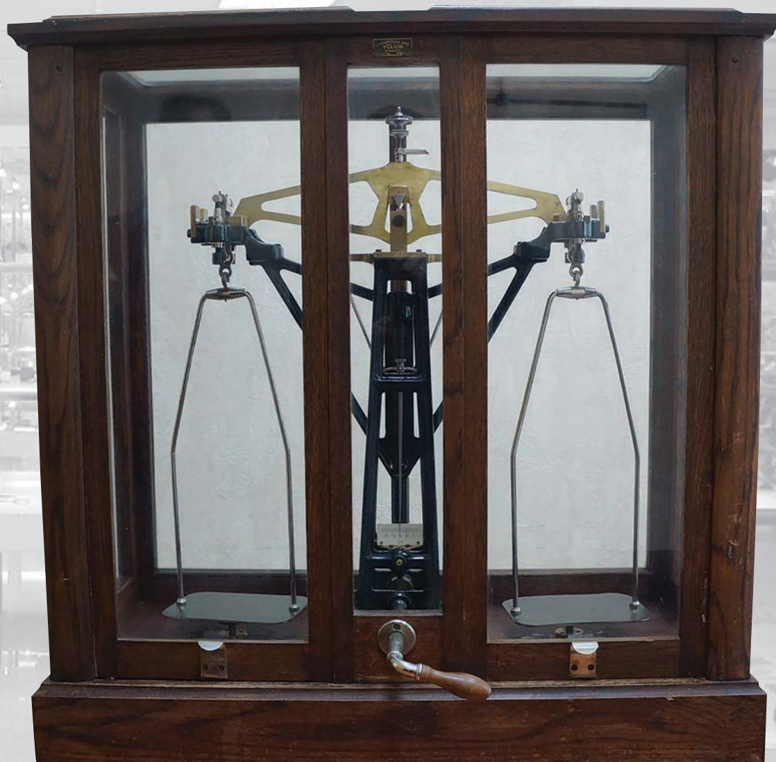
Весы образцовые равноплечие, НПВ 5 кг Экспериментальный завод «Эталон» ВНИИМ, 1939 г.
