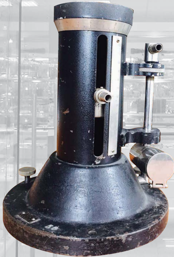
Образцовый микрометр МКВ 160-0,02. СССР, 1947 г.
