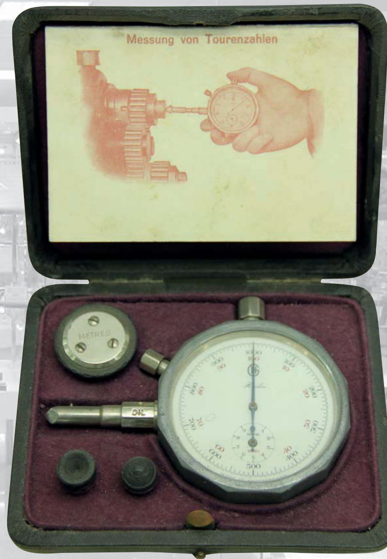
Тахометр часового типа Rockwell модификации JR. Производства Wilson mechanical instruments CO.INC., США, 1945г.
