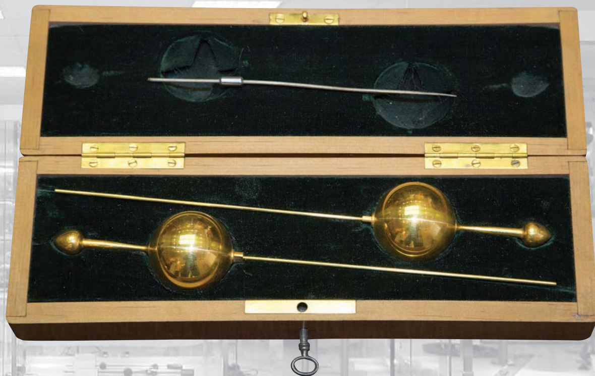
Образцовый металлический спиртометр 1-го разряда. г. Ленинград, Главликерводка, 1940 г.
