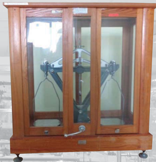
Весы, предельная нагрузка 5 кг (ВО-5 кг III разряд) Изготовитель: завод «Эталон», г. Рига, 1957 г.
