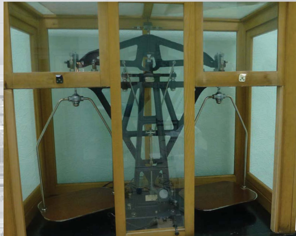
Весы образцовые ВЛТ-20 кг-II разряда, цена деления 5 мг, 1965 г.
