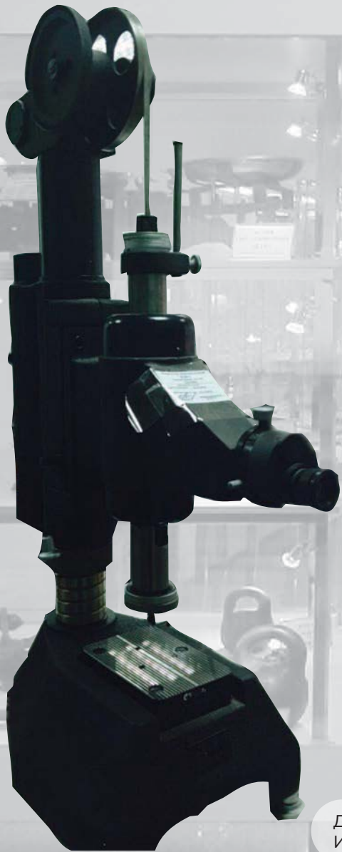
Образцовый микрометр МКВ 160-0,02. СССР, 1947 г.
