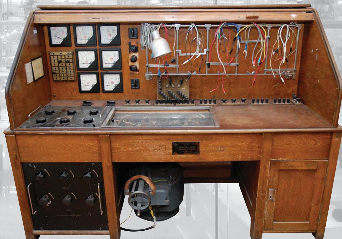
Установка для поверки трехфазных счетчиков тип УПС-1 Экспериментальный завод «ЭТАЛОН», г. Ленинград, 1953 г.
