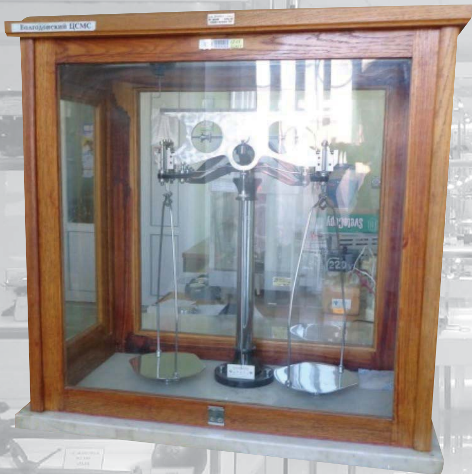
Весы, предельная нагрузка 1 кг (ВО-1 кг II разряд) Изготовитель: завод «Эталон», г. Рига, 1958 г.
