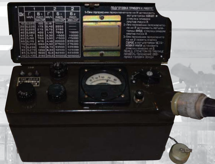
Полевой бета-гамма-радиометр ДП-11-Б, 1958 г.
