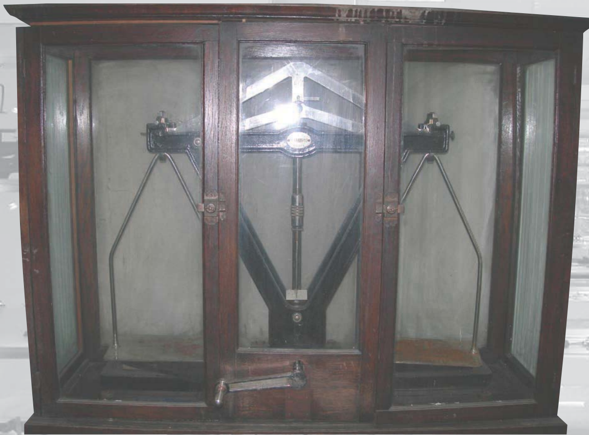
Весы образцовые рычажные с НВП 50 кг. Завод-изготовитель: ГОСТРЕСТ точной механики, г. Москва, 1924 г.
