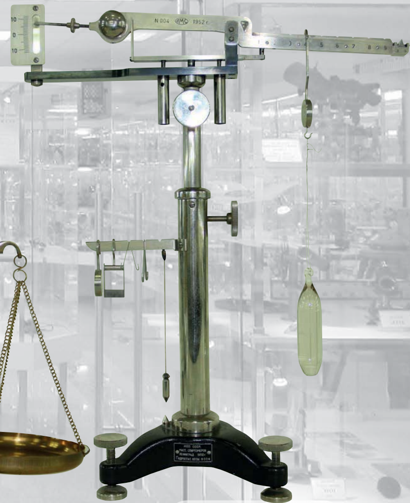
Весы гидростатические ВГ-2. Мастерская спиртомеров Ленинград, 1954 г.
