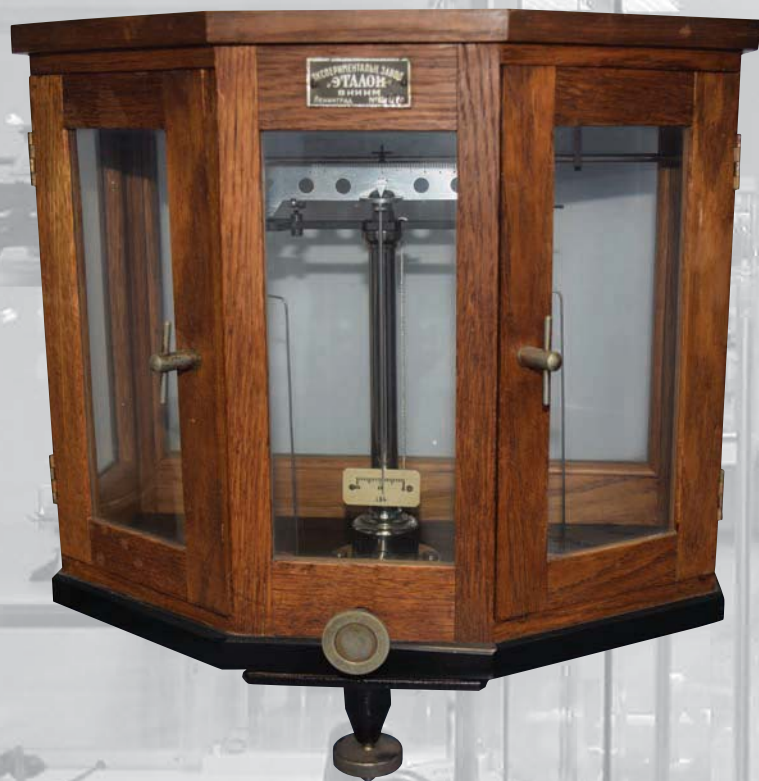
Весы лабораторные 2 класса. Экспериментальный завод «Эталон» ВНИИМ, г. Ленинград
