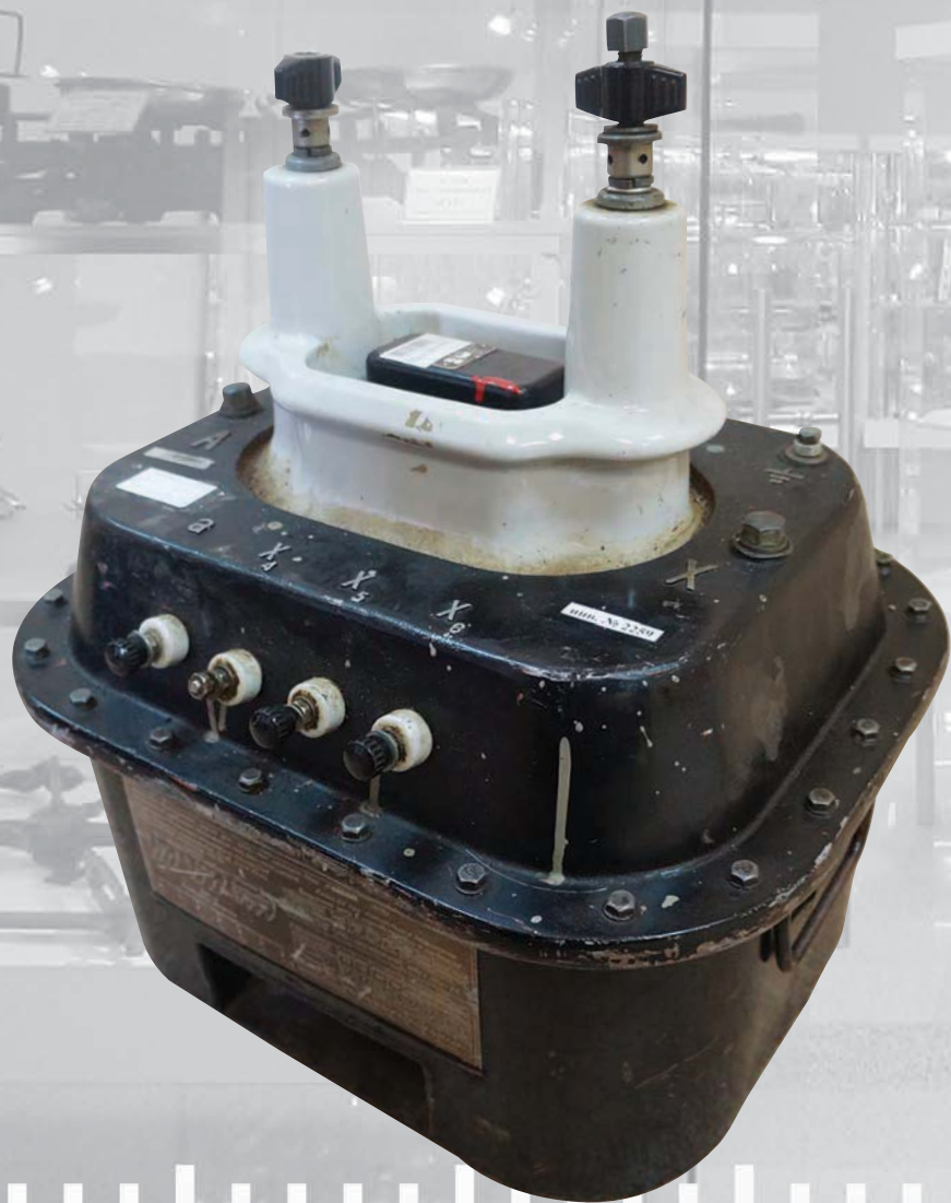
Трансформатор напряжения лабораторный типа И50 ПО «Точэлектроприбор», г. Киев, 1959 г.
