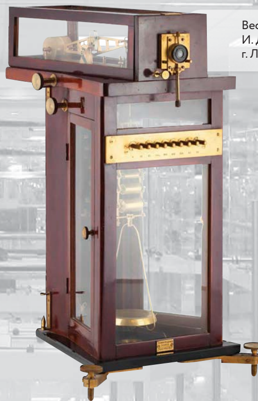
Весы хлебные — Гамбургская пурка в 1/360 голландского мешка (0,2 л). Россия, г. Санкт-Петербург. Механик И. К. Манцевич. Конец XIX в. Служила для определения качества (натуры) зерна при купле-продаже. Названа «гамбургской» по месту ее первоначальной поверки и клеймения.
