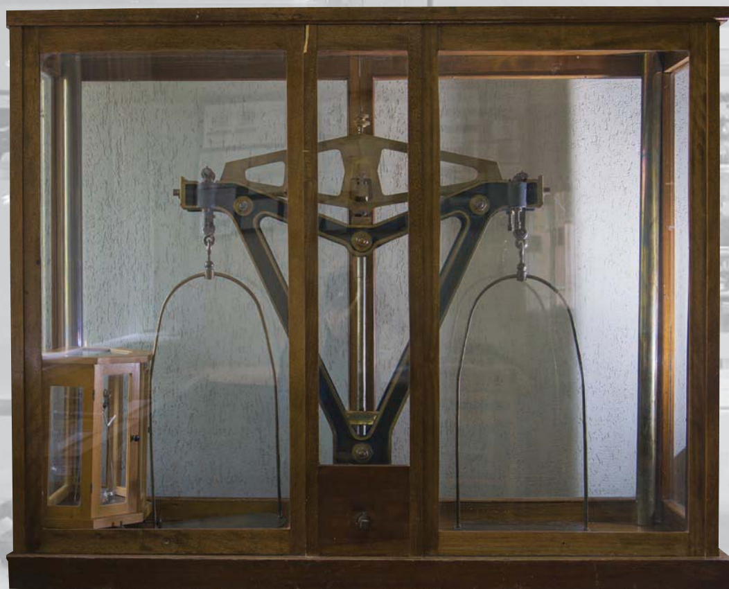
Весы лабораторные до 50 кг, 1953 г.
