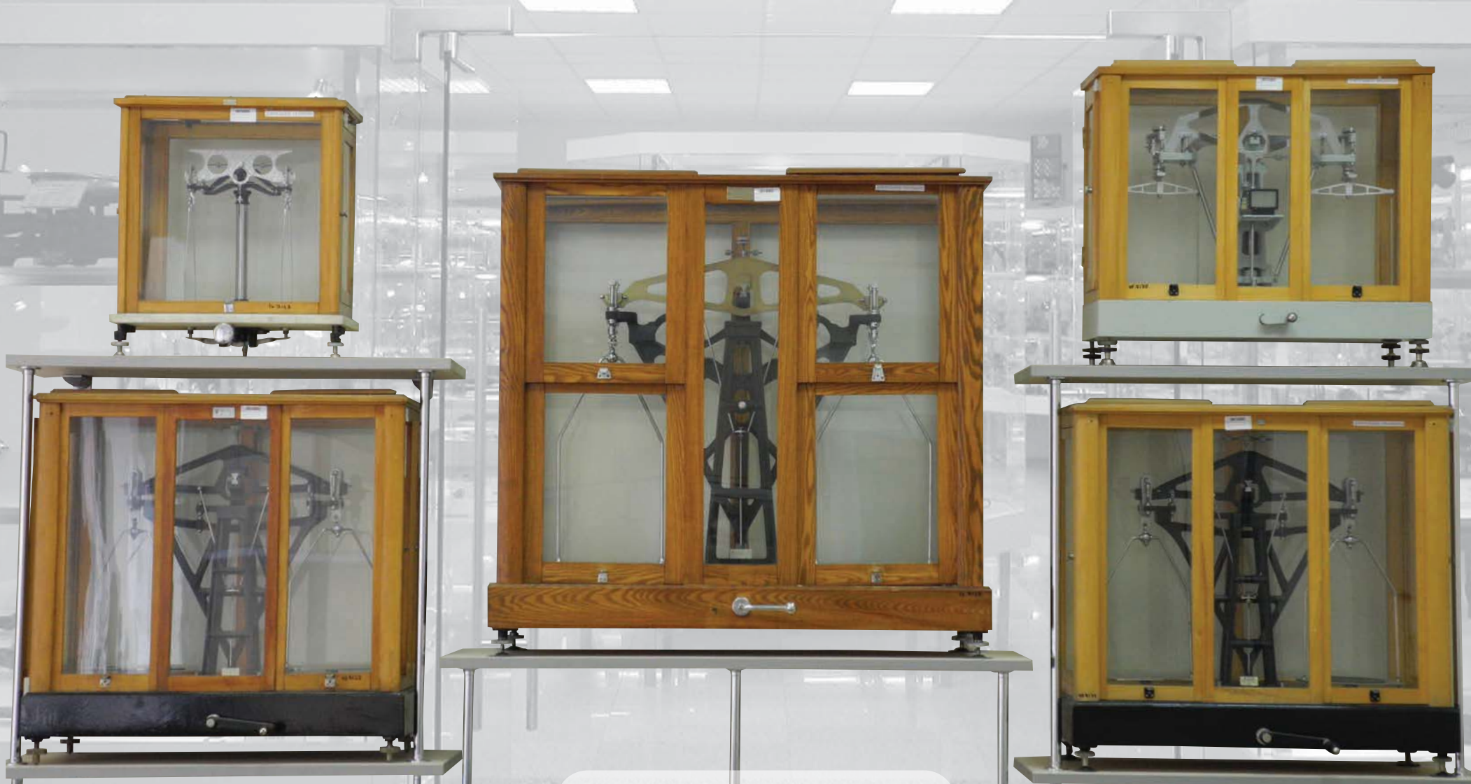
Образцовые весы для поверки гирь Изготовитель: «Госметр», г. Ленинград, 1950 г.
