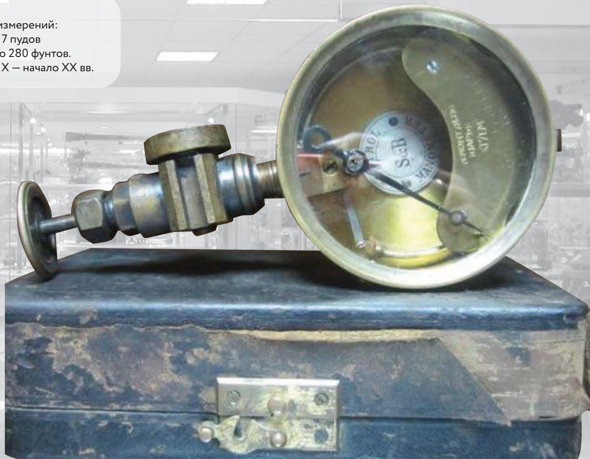
Манометр контрольный КТ-1,0 Предел измерений от 0 до 25 кгс/см 2 Изготовитель: фирма Smit & Betson (начало XX века).
