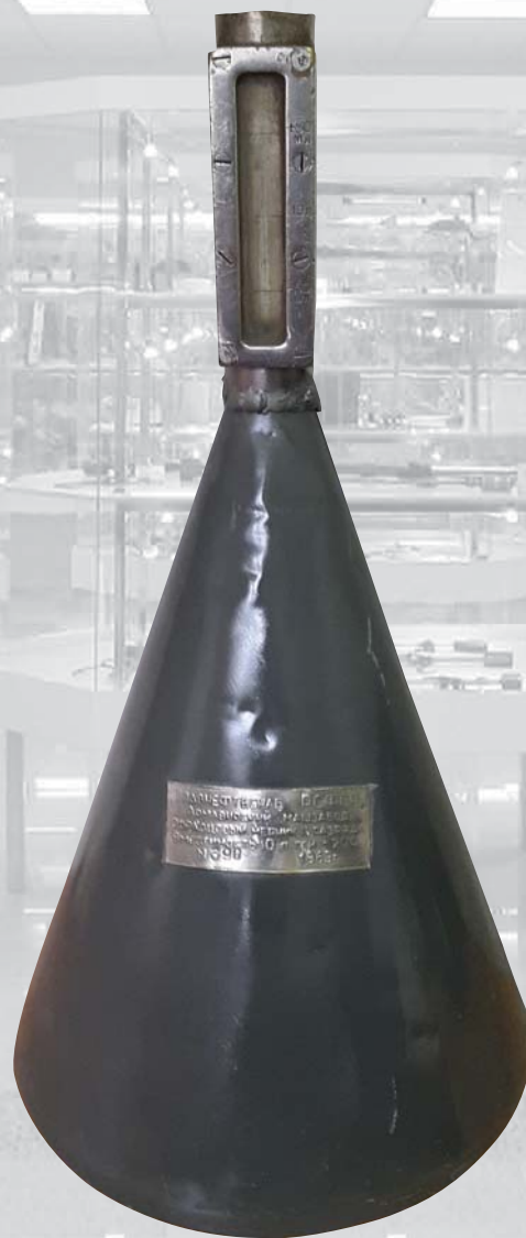
Образцовый мерник II разряда, вместимость 10 л Армавирский машзавод, 1963 г.
