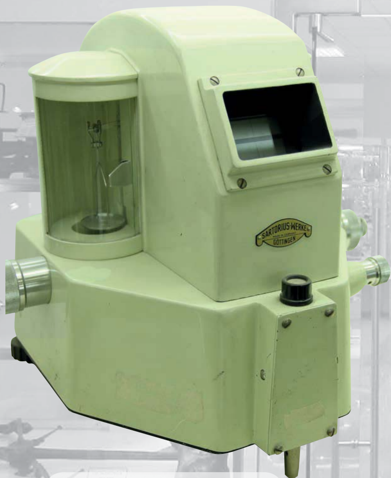
Микровесы Sartorius-Werke Gottingen. Германия, 1961 г.
