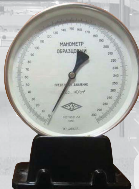
Манометр образцовый КТ-0,4 Предел измерений от 0 до 40 кгс/см 2 , Изготовитель: Московский завод «Манометр», 1956 г.
